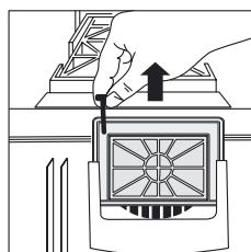
**...om pappersfiltret skulle komma att skadas och HEPA-filtret är smutsigt, ta ur HEPA-filtret, rengör det (piska) och sätt åter in det. Lägg i nytt pappersfilter.**
