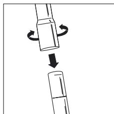
**Соединение деталей трубы**
