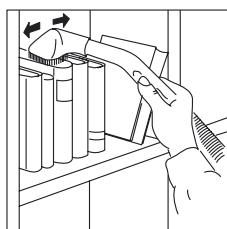
Pędzel do mebli z przegubem obrotowym
