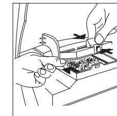
Klap het deksel open tot het vastklikt. Haal het opgebruikte microfilter (afbeelding) er aan het lipje uit en geef het met het huisvuil mee. Zet het nieuwe microfilter er in.
