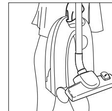
Чтобы облегчить хранение и транспортировку пылесоса, Вы можете вставить насадку для пола в проем для вертикального положения.
