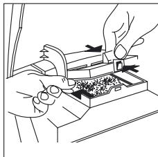
Откройте крышку и откиньте ее до упора. Использованный микрофильтр должен быть вынут за язычок (см. рисунок) и выкинут в бытовой мусор. Вставьте новый микрофильтр.
