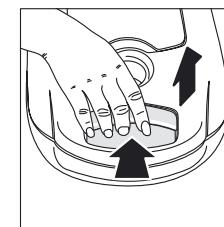
С помощью нажатия кнопки открывается и откидывается затем до упора.
