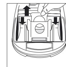
Гигиеничный способ замены фильтра: при выемке заполненного пылевого мешка за язычок его отверстие автоматически затягивается. При вытягивании Вы должны преодолеть некоторое сопротивление.
